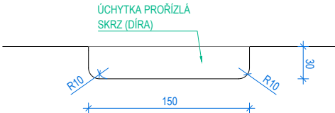
DETAIL ÚCHYTKY U3 VNITŘNÍHO ŠUPLÍKU 1:5
